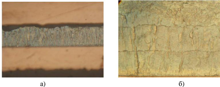
Рис. Структура цинкового покрытия в поперечном сечении, осажденного: а) на постоянном токе, б) при лазерном стимулировании ( $\times 600$ )
